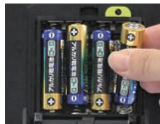
2. 使用済み電池を取り外し、電池を交換して下さい。
